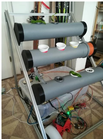
Obrázek 18: Výsledná podoba hydroponie
